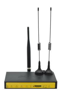
F8926-GW 基站是一种基于 LoRaWAN 协议的无线通信基站,接入 各类应用节点的 LoRaWAN 终端, 采集到的信息通过 3G/4G 或有线以太 网方式传送到云端服务器。该产品采用高性能的工业级 32 位通信处理 器和工业级无线模块,以嵌入式实时操作系统为软件支撑平台,同时提 供 1 个以太网 WAN/LAN 可配置, 1 个 LAN, 1 个 WIFI 接口, 支持 WIFI 无线配置管理和在线升级, DC 供电。
