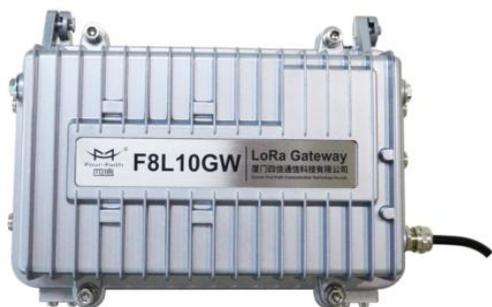
F8L10GW 基站是一种基于 LoRaWAN 和 LinkWAN 协议的无线通信基站，接入各类应用节点的 LoRaWAN 终端，采集到的信息通过 3G/4G 或有线以太网方式传送到云端服务器。该产品采用高性能的工业级 32 位通信处理器和工业级无线模块，以嵌入式实时操作系统为软件支撑平台，同时提供 1 个以太网 LAN，1 个 WIFI 接口，支持 WIFI 无线配置管理和在线升级，支持 GPS 定位，支持 220V 市电、可选 POE 供电、可选直流电源等方式供电。
