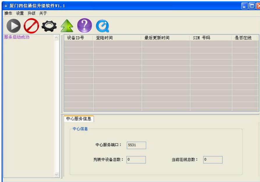
步骤 4. 登录水文监测管理平台，鼠标移动到要升级的 RTU 设备，点击右键，跳出指令操作界面，选择“远程升级”.填写远程升级软件所在的服务器 IP 地址、端口和程序版本
