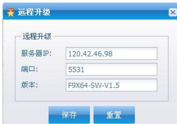
步骤 5. 需要升级的设备重启连接到远程升级软件所在的服务器和端口，程序开始远程升级
