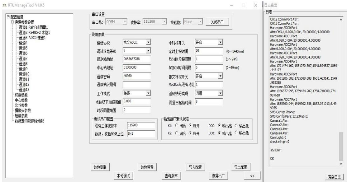
参数配置软件使设备进入配置状态后会自动载入设备中的当前配置参数，并显示在右边的“日志信息”中，至此可以开始配置设备中所有配置参数。
