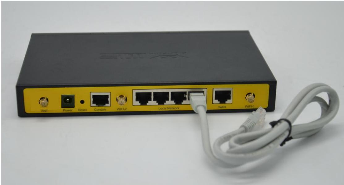
将 RS232 控制台线的 RJ45 端插到 Router 的 RS232 接口上（标识为“Console”），另一端插到用户设备的 RS232 串行接口上。RS232 控制台线的信号连接如下：
