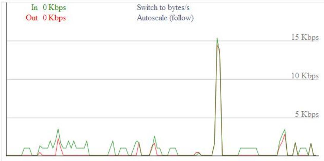
WAN 口的时时检测状态图横坐标代表时间纵坐标代表速率
