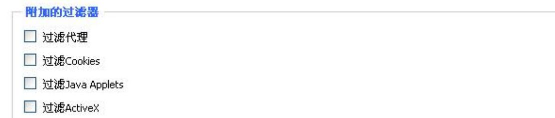
**过滤代理：**使用 wan 代理服务器可能降低网关的安全性，过滤 Proxy 将拒绝任意对任意 wan 代理服务器的访问，单击该复选框启用 Proxy 过滤或反选以禁用该功能。
