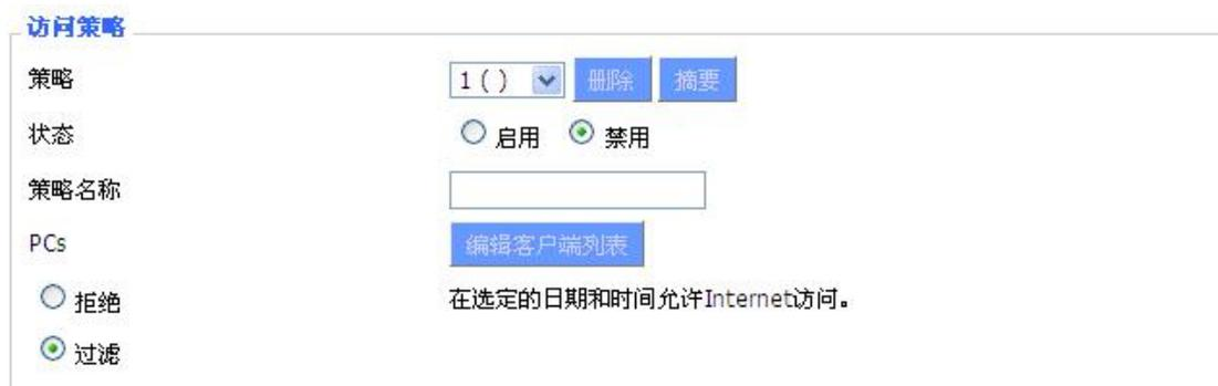
默认策略规则中有“过滤”和“拒绝”两种选项，如果选择“拒绝”，将拒绝特定的电脑在特定时间段访问任何互联网服务；如果选择“过滤”，将阻止特定电脑在特定时间段对特定的网站的访问；您可以设置 10 条 Internet 访问策略过滤特定的 PC 在特定时间段访问的 Internet 服务。
